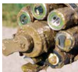
État du capteur après 90 jours de déploiement.
